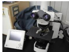
写真2 位相差分散顕微鏡 (例) Eclipse 80i (NIKON 製) 対物レンズ Ph1 D 10×/0.25
